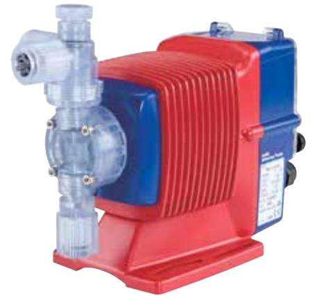
Las bombas EWN ofrecen caudales de hasta 6.7 GPH (25.2 L/h) y una presión máxima de 250 PSI (17 bar). La alta velocidad de operación resulta en una dosificación química de alta resolución y una larga vida de servicio. Silenciosa y compacta, la bomba de EWN se ceba en segundos y mantiene el cebado en forma confiable.
