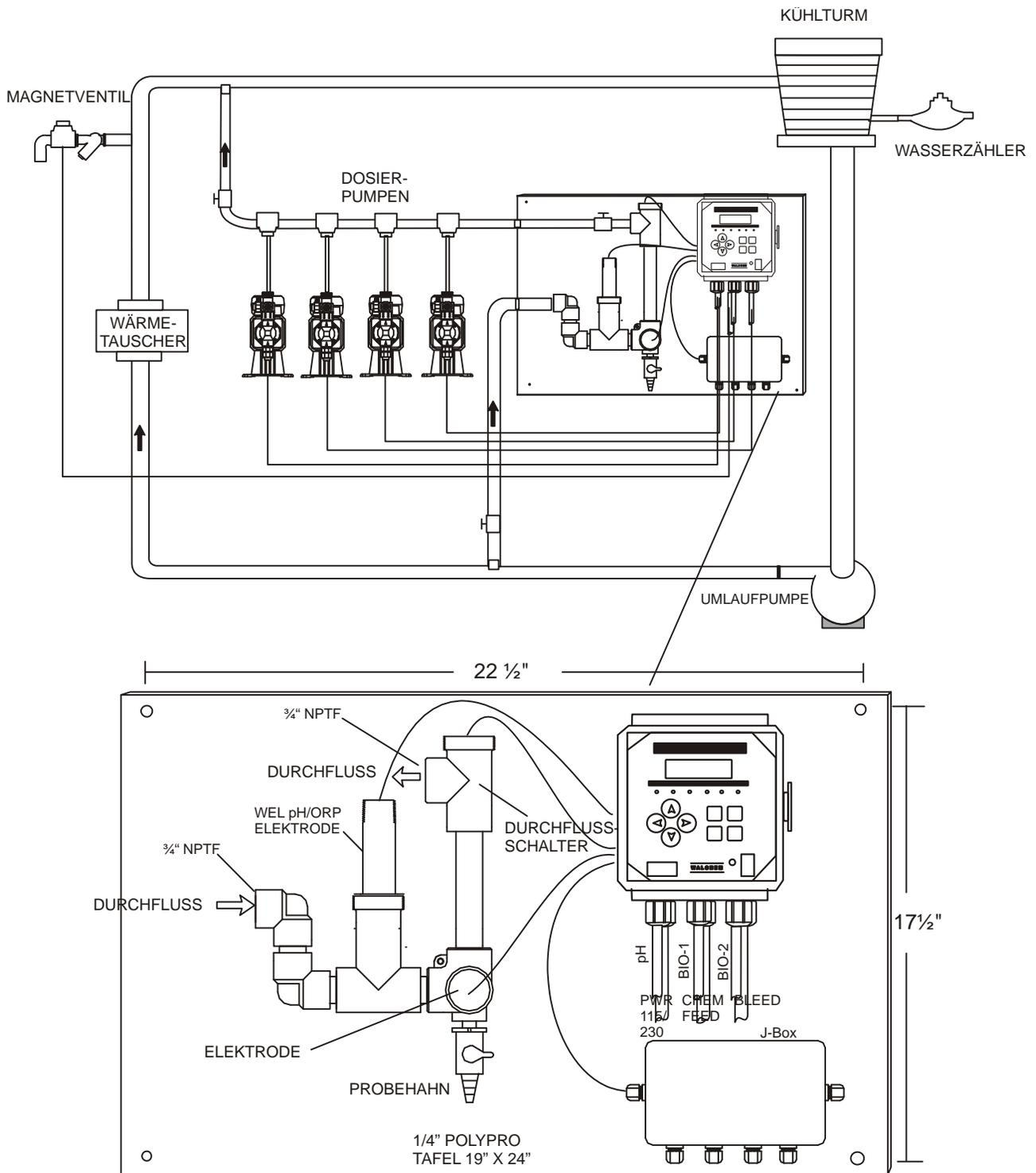
**Abbildung 2 Typische Installation**
