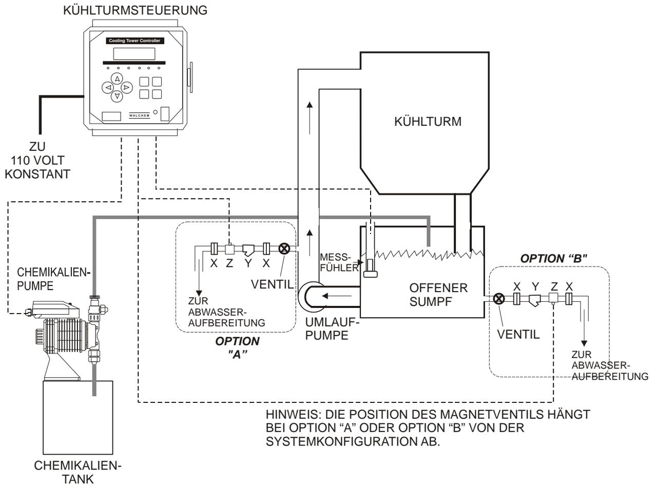
(X) Anschlüsse, installiert zwecks Austausch von Elektromagnet oder Sieb
