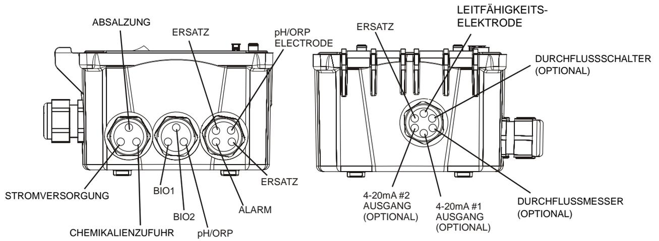
**Abbildung 1 Isolierrohr-/Kabelkonfiguration**
