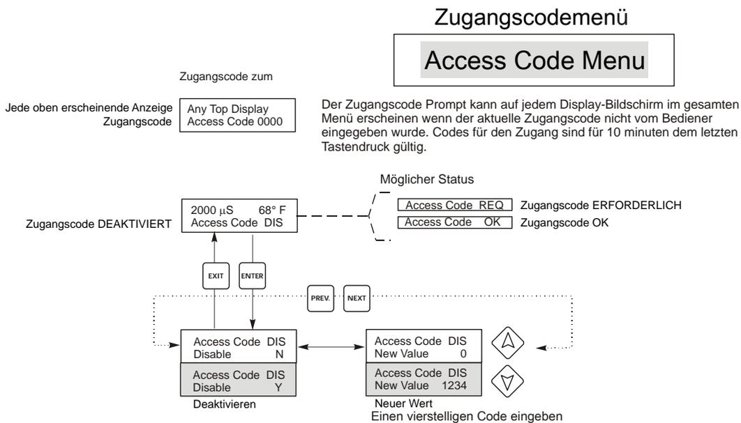
**Abbildung 22 Zugangscodemenü**
