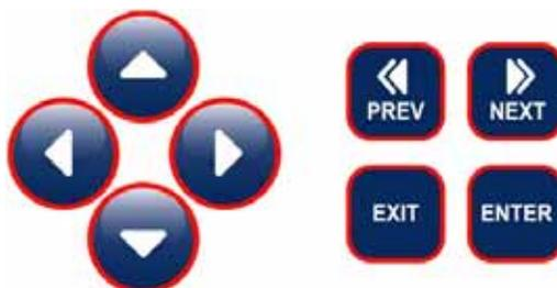
Para cambiar un valor en un submenú, las teclas flecha derecha/izquierda mueven el cursor a la izquierda y derecha de cada dígito u opción que pueda cambiarse. Las teclas flecha arriba/abajo cambiarán los valores numéricos hacia arriba o hacia abajo, o lo desplazarán a través de las opciones. Presione ENTER únicamente cuando haya terminado de hacer todos los cambios para ese menú en pantalla.
