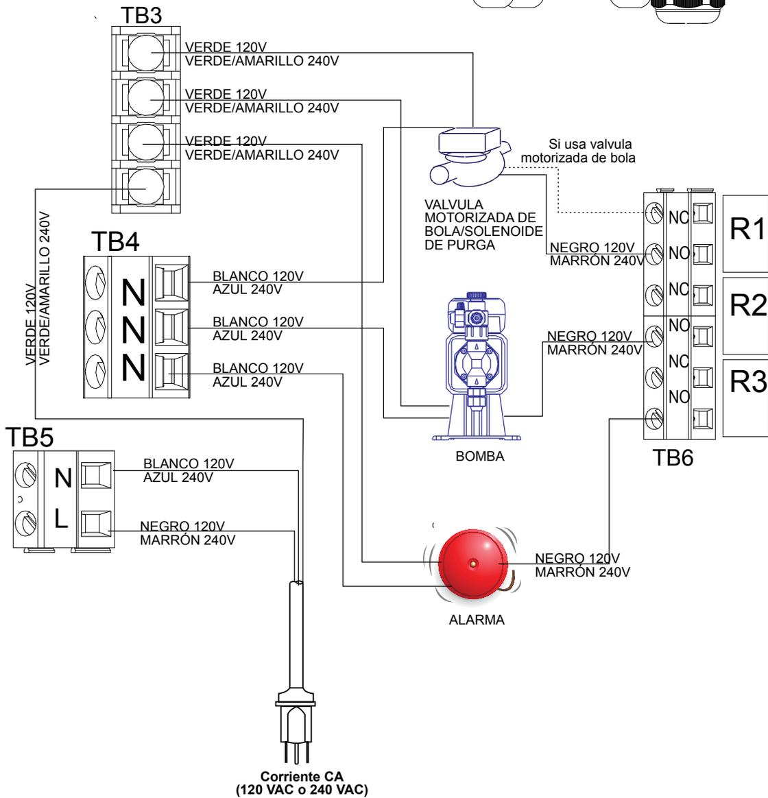
Figura 11 Cableado de salida de relé y corriente CA de W100
