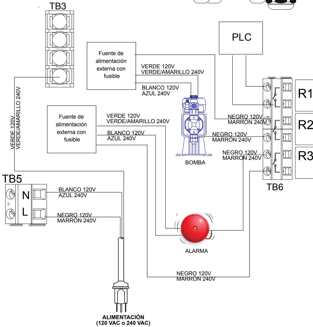
Figura 12 Cableado de salida de relé y corriente CA de W110
