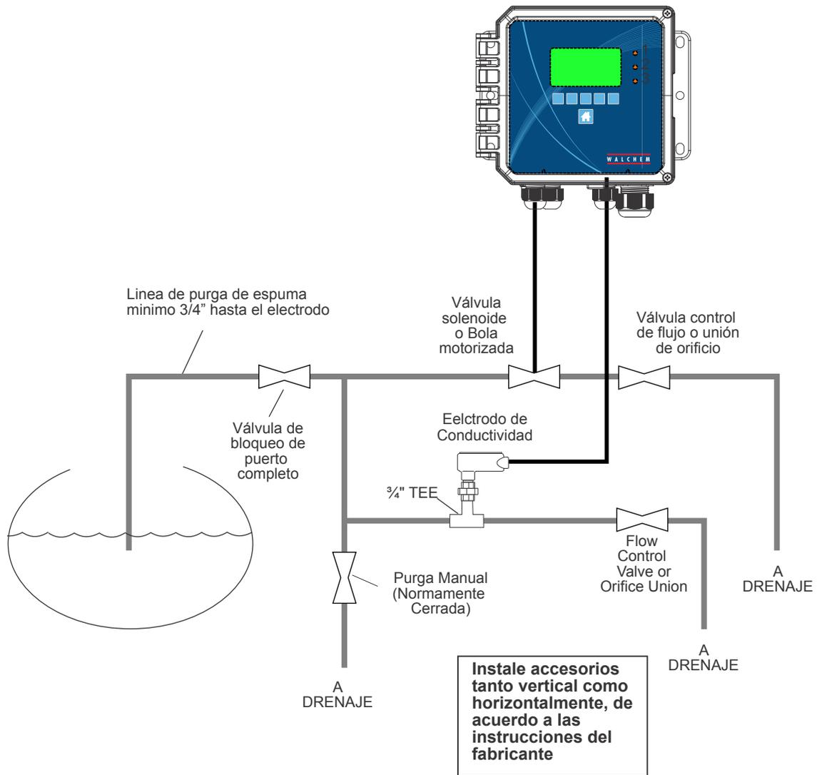
**Figura 4 Instalación típica de caldera con muestreo continuo**
