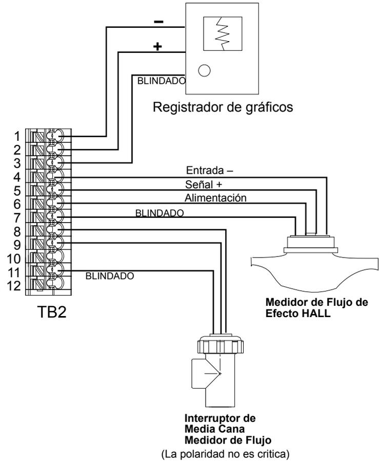
Figura 10 Cableado de entrada digital y salida analógica
