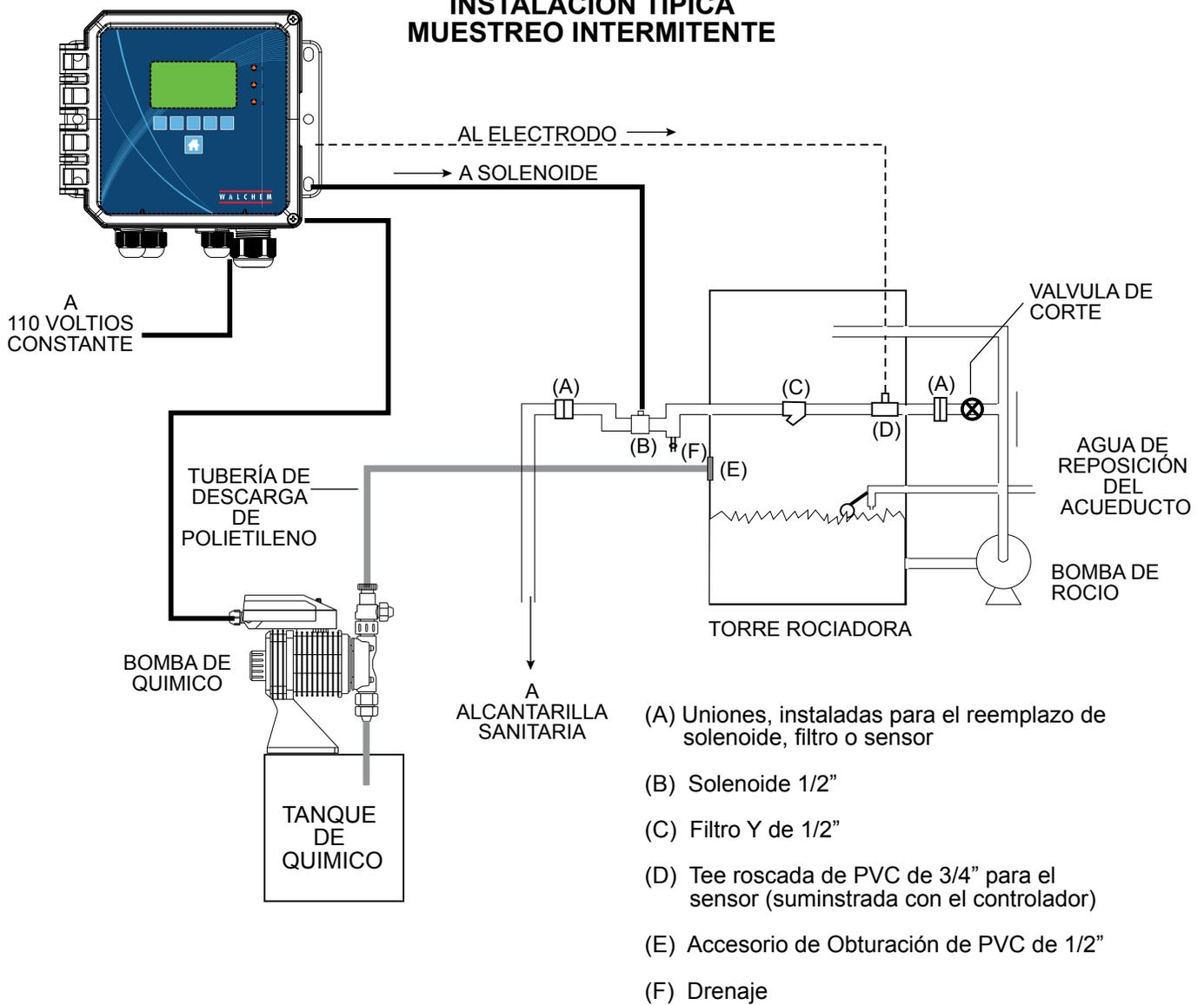
**Figura 6 Instalación típica de torre de enfriamiento con muestreo intermitente**
