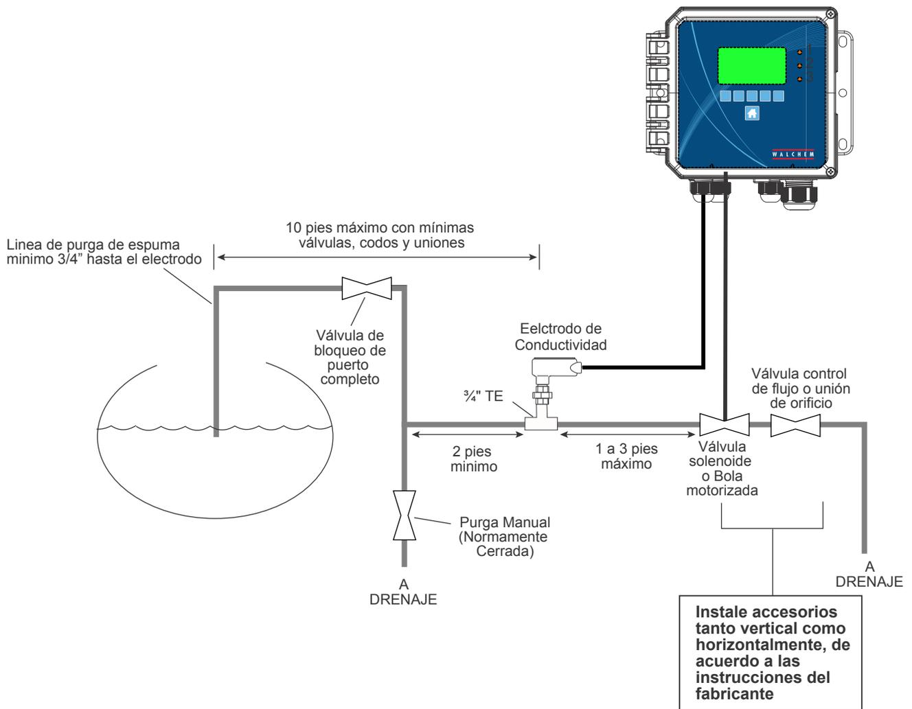
**Figura 3 Instalación típica de caldera con muestreo intermitente**
