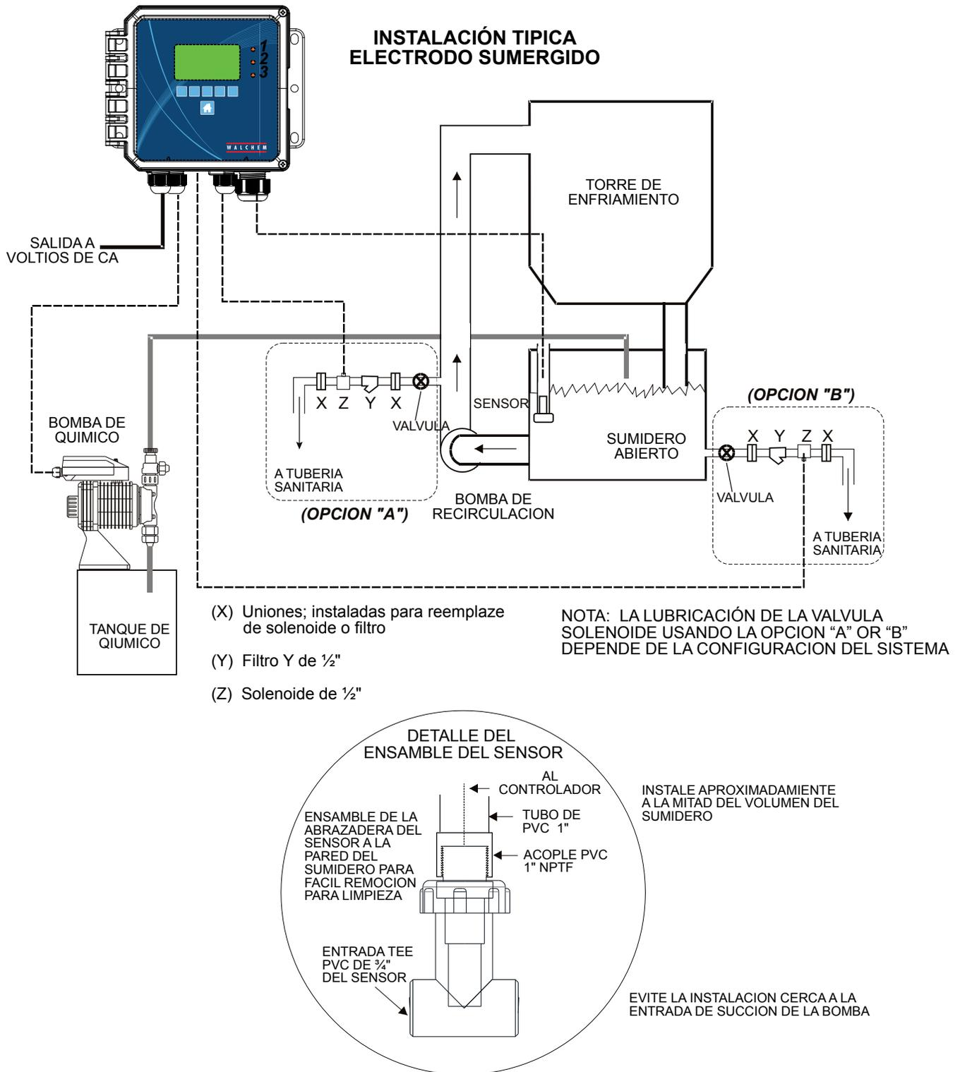
**Figura 5** Instalación típica de torre de enfriamiento con sensor de inmersión
