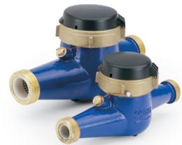
La Serie WFM utiliza un principio de chorro múltiple ampliamente reconocido, el cual ha sido aceptado como una norma internacional durante muchos años. Estos medidores se encuentran disponibles con un interruptor de láminas de dos cables, o con un sensor de efecto Hall de estado sólido, de tres cables.
