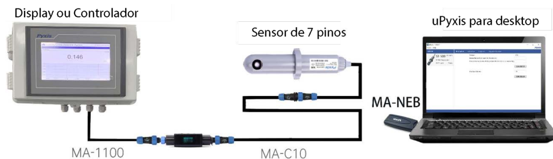
Figura 12. Conexão USB para o sensor da série ST-730 com MA-WB, MA-NEB e o aplicativo uPyxis para desktop.
